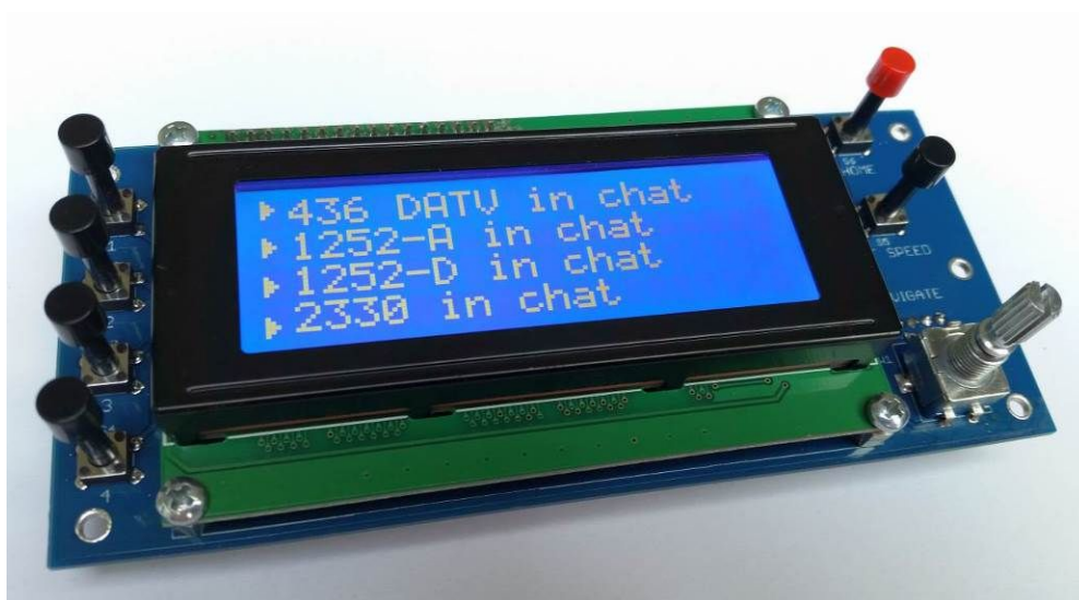
Voorzijde toont tevens hoe het display op de onderdelenprint is gemonteerd
